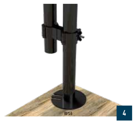
4 Mithilfe der Doppelklammer kann die Halterung an vorhandene Rohre mit einem maximalen Durchmesser von 35 mm befestigt werden.
