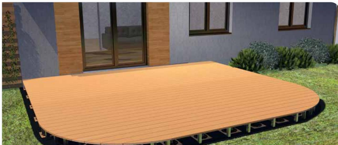
Mise en place des lames pour la surface de plancher
