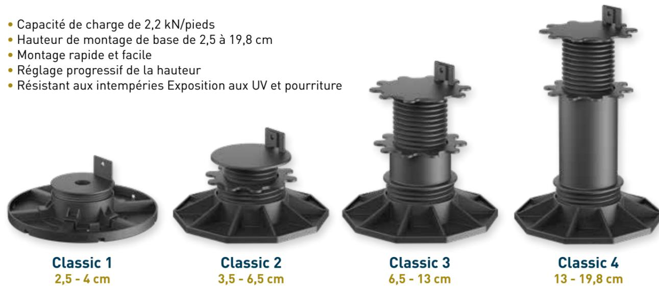
\* Les valeurs de capacité de charge indiquées sont des valeurs recommandées. À ces charges, les bases réglables ne se déforment que d'environ 2 mm. La capacité de charge jusqu'à la rupture effective est plusieurs fois supérieure.
