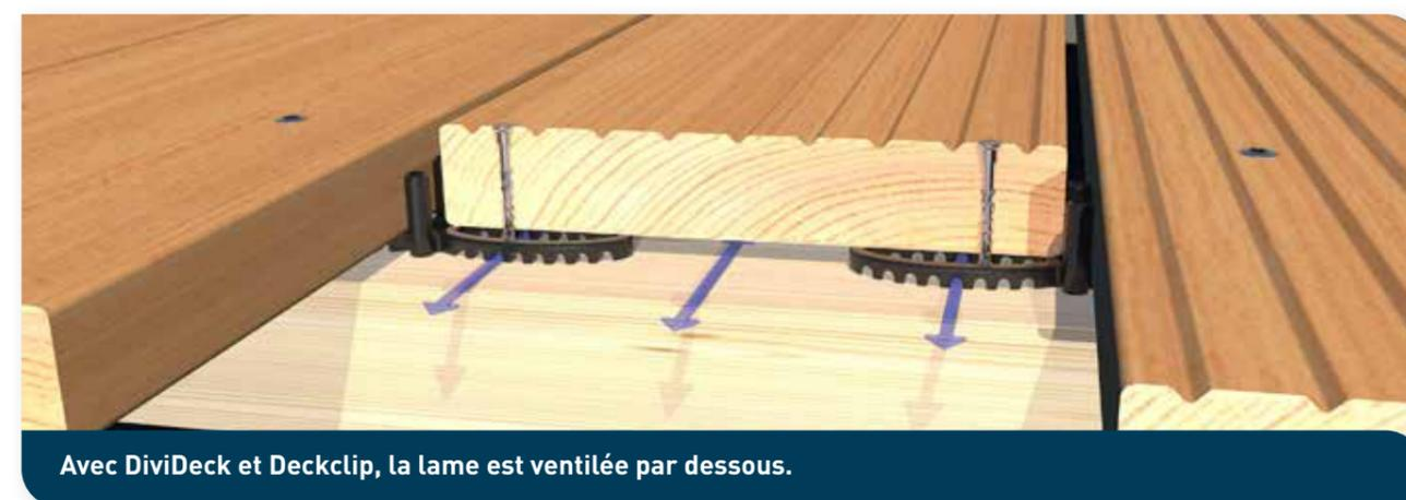
Avec DiviDeck et Deckclip, la lame est ventilée par dessous.
